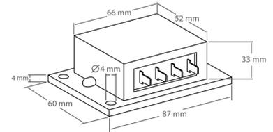
Dieser Batteriewächter schützt Ihre Autobatterie vor Tiefentladung durch das rechtzeitige Abschalten von Verbrauchern wie Kühlboxen, Heizungen, Radios, Fernsehgeräten, usw. Er schaltet automatisch wieder ein nach Wiederkehr der normalen Spannung. Die Abschaltspannung ist einstellbar: ca. 10,4 - 13,3 V.
