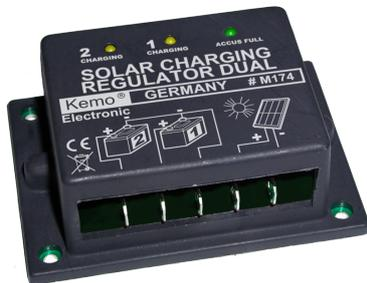
Wird zwischen Solarpanel 12 V/DC und 1 oder 2 Akkus geschaltet, um ein Überladen der Akkus zu verhindern. Sind 2 Akkus angeschlossen, werden diese getrennt voneinander geladen. Es bekommt immer der Akku mehr Ladestrom, der die niedrigste Ladespannung hat. Mit LED-Anzeigen + hoher Ladeleistung: max. 2 x 8 A oder 1 x 16 A.
