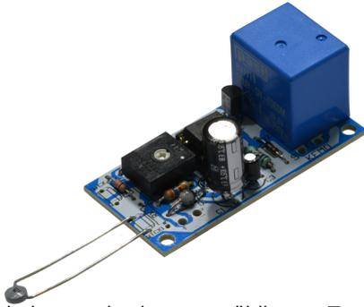
Schaltet nach einer vorwählbaren Temperatur das Relais ein oder aus. Ideal als Thermostat, Eiswarner, Feuermelder usw.
