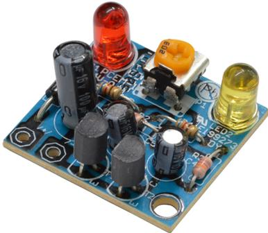
2 verschiedenfarbige Leuchtdioden blinken abwechselnd auf. Die Blinkfolge ist regelbar. Die Betriebsspannung beträgt 6 - 12 V/DC. Damit ist der Blinker für den Batteriebetrieb an einer 9 V-Transistorbatterie geeignet.
