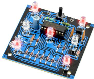
Dieses Gerät soll bei Würfelspielen den altmodischen Würfel ersetzen. Auf der Platine sind 7 Leuchtdioden so angebracht, wie die Augen auf einem Würfel angeordnet sind. Nach dem Drücken und wieder Loslassen der Starttaste leuchten zufallsbedingt eine oder mehrere der LED`s auf. Die Anzeige entspricht den Augen eines Würfels, wenn jeweils die 1, 2, 3, 4, 5 oder 6 angezeigt wird. Die letzte Anzeige bleibt solange stehen, bis die Starttaste erneut gedrückt wird.
