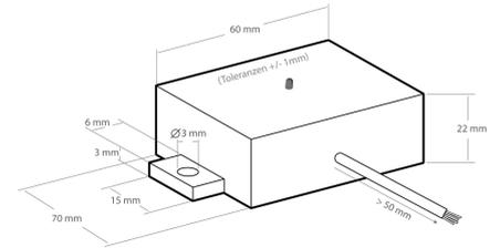
Dieser elektronische Dämmerungsschalter schaltet über ein eingebautes Relais automatisch Lampen (z.B. Energiesparlampen) oder andere Verbraucher bei Dämmerung ein und bei Tagesanbruch wieder aus. Das Modul kann auch umgekehrt arbeiten: bei Tagesanbruch ein (für Werbedisplays, Springbrunnen usw.) und bei Dunkelheit aus. Es können potentialfrei Lasten bis 3 A geschaltet werden.
