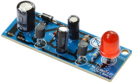
Elektronischer Blinkgeber mit einer großen Ø 8 mm Leuchtdiode.
