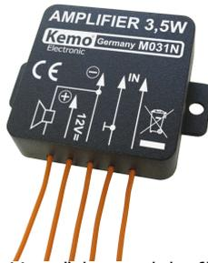
Robustes Verstärkermodul für den universellen Einsatz. Das Modul ist feuchtigkeits- und rüttelfest vergossen. Die Vergussmasse und das Modulgehäuse bestehen aus einem speziellen, hoch wärmeleitfähigen Kunststoff. Daher sind keine zusätzlichen Kühlkörper erforderlich. Das Modul ist elektronisch gegen Überhitzung und Überlastung gesichert.
