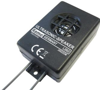
Zusatzlautsprecher (Piezo) für unsere M071N - Ultraschall-Ungeziefer-Scheuche. Mit eingebauter Leuchtdiode als Betriebsanzeige. Alu-Kalottenmembran mit besonders breitem Abstrahlwinkel. Für Außenmontage geeignet, wenn der Lautsprecher regengeschützt montiert wird (z.B. unter Dachüberständen). Die LED wird von der zugeführten Ultraschallfrequenz gespeist und braucht keine extra Betriebsspannung.
