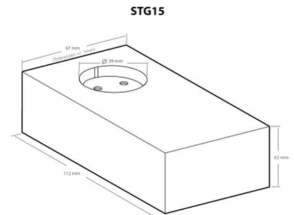
Schwarzes Kunststoffgehäuse mit angespritztem Schutzstecker und eingespritzter Schutzkontaktsteckdose (jeweils mit Erdungsbügel) und Lüftungsschlitzen. Für den Selbsteinbau von Netzteilen und Spannungswandlern usw.
