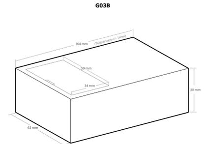
Zweischaliges schwarzes Kunststoffgehäuse mit großem Batteriefach zur Aufnahme einer 9 V-Blockbatterie oder einen Batteriehalter für 2 AAA-Batteriezellen mit Schiebedeckel für das Batteriefach.
