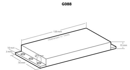
Wandgehäuse mit Befestigungslaschen zum Einbau von Platinen im halben Euro-Format. Durch den Klarsichtdeckel bleibt die Schaltung sichtbar. Ideal zum Einbau von Schaltungen mit vielen optischen Signalgebern (LED's).
