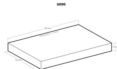
Gehäuse zum Einbau von Platinen im halben Euro-Format. Durch den Klarsichtdeckel bleibt die Schaltung sichtbar. Ideal zum Einbau von Schaltungen mit vielen optischen Signalgebern (LED's).
