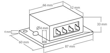
Regelt stufenlos 12 V/AC Motoren (auch Gleichstrommotoren mit vorgeschaltetem Gleichrichter), Glühlampen, Heizungen usw. Nur zum Betrieb an einem 12 V/AC Trafo (50 - 60 Hz), nicht für Gleichspannung (Akku). Durch Austausch des Potentiometers können auch Spannungen wie 24 V/AC oder 48 V/AC geregelt werden.
