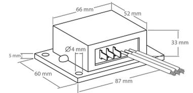
Leistungsregler zum Regeln von Gleichspannungslasten (Gleichstrommotoren, Glühlampen, Heizungen, LED`s mit Vorwiderständen usw.). Durch die verwendete PWM (Impulsbreiten)-Steuerung laufen Elektromotoren auch in kleinen Drehzahlen gut an.
