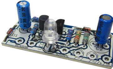
Wenn 2 blanke Drähte mit Wasser in Berührung kommen, leuchtet eine Leuchtdiode auf. Das Gerät ist geeignet, überlaufende Regentonnen und Dachrinnen zu melden. Betriebsspannung: 9 V/DC.
