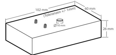
Mit diesem Suchgerät können Abhörsender, die im Raum, im Computer oder im Telefon aktiv sind, geortet werden. Damit ist es möglich, versteckte Abhörsender (Wanzen, Minispione) zu finden.
