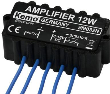
Robustes Verstärkermodul für den universellen Einsatz. Das Modul ist feuchtigkeits- und rüttelfest vergossen. Die Vergussmasse und das Modulgehäuse bestehen aus einem speziellen, hoch wärmeleitfähigen Kunststoff. Daher sind keine zusätzlichen Kühlkörper erforderlich. Das Modul ist elektronisch gegen Überhitzung und Überlastung gesichert.
