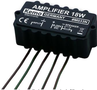
Robustes Verstärkermodul für den universellen Einsatz. Das Modul ist feuchtigkeits- und rüttelfest vergossen. Die Vergussmasse und das Modulgehäuse bestehen aus einem speziellen, hoch wärmeleitfähigen Kunststoff. Daher sind keine zusätzlichen Kühlkörper erforderlich. Das Modul ist elektronisch gegen Überhitzung und Überlastung gesichert.
