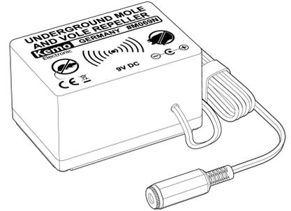
Dieses wasserdichte Modul erzeugt in schnellen Intervallen aggressive seismische Schwingungen, die sich in der Erde gut ausbreiten und von Wühlmäusen, Maulwürfen und ähnlichen Nagern weitgehend gemieden werden. Das Modul wird in der Nähe der Tiergänge eingegraben und über ein Kabel mit der Betriebsspannung von 9 V/DC versorgt. Ein Modul reicht für max. 1.000 m<sup>2</sup> Gartenfläche.
