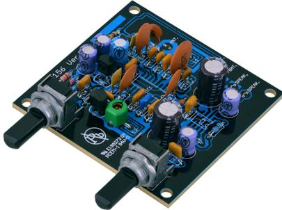
Bausatz für UKW Radio. Mit dem eingebautem Audioverstärker können Lautsprecher mit 8 Ohm > 1 W betrieben werden. Vormontierte SMD-IC's und fertig gedruckte Spulen erleichtern den Zusammenbau. Der Bausatz kann mit einer 9 V Batterie betrieben werden.
