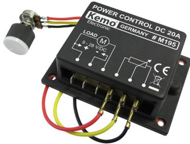
Leistungsregler zum Regeln von Gleichspannungslasten (Gleichstrommotoren, Glühlampen, Heizungen, LEDs mit Vorwiderständen usw.) Durch die verwendete PWM (Impulsbreiten)-Steuerung laufen Elektromotoren auch bei kleinen Drehzahlen gut an. Schaltfrequenz: ca. 300 - 600 Hz (bei Motoren kann ein Brummgeräusch hörbar sein). Die Regelung erfolgt über das mitgelieferte Potentiometer oder auch wahlweise mit einer externen Steuerspannung 0 - 5 V/DC.
