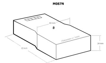
Mit diesem Prüfmodul können bedrahtete Leuchtdioden auf Funktion, Helligkeit, Farbe und Polarität geprüft werden. Zum Selektieren von LED's auf gleiche Helligkeit sind 2 nebeneinanderliegende Prüfbuchsen mit gleichen Strömen (5 mA/10 mA) angeordnet. Erforderlich: Batterie 9 V (Alkali).
