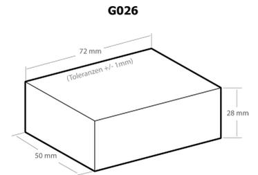
Mit einer Wandstärke von 1,8 mm. Lieferung mit vier Befestigungsschrauben für den Gehäusedeckel.
