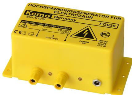
Elektrozaungerät für die Kleintierabwehr (Marder, Hunde usw.). Für Zaunlängen bis ca. 1 km (ohne Bewuchs). Hochspannungsimpulse: max. 2400 V im Takt >1,2 Sek. Extrem niedriger Stromverbrauch:  $\emptyset$  0,008 A. Zum Betrieb ist noch ein Steckernetzteil 12 V/DC, Leistung mind. 100 mA oder ein 12 V Autoakku >12 Ah erforderlich (beides liegt nicht bei). In beiden Fällen benötigt das Stromkabel einen Hohlstecker 5,5 x 2,1 mm.
