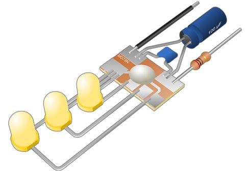
Sehr kleiner, hoch integrierter Blinkgeber, der wahlweise als Blinker oder Wechselblinker oder Lauflicht für 1 bis max. 6 LEDs eingesetzt werden kann.
