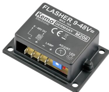
An diesen Blinkgeber können entweder Glühlampen oder LED Lampen mit Betriebsspannungen zwischen 9 - 48 V/DC angeschlossen werden. Der Blinkgeber wird dann mit der Betriebsspannung betrieben, die die angeschlossenen Lampen haben. Das Gerät ist kurzschlussfest. Blinkfolge regelbar ca. 0,15 - 7 Sek.
