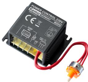
Regelt ohne zusätzlichen Entstörbedarf ohmsche Lasten wie Heizungen usw. mit Impulsen im Nulldurchgang. Die Regelung erfolgt, indem impulsweise ein- und wieder ausgeschaltet wird. Daher nur für Heizungen (Wärmeplatten, Schweißdrähte, thermische Schweißmaschinen, Öfen usw.) geeignet. Nicht für Motoren + Lampen (die würden stottern bzw. blinken).
