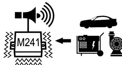
Vibrationsschalter, schaltet 12 V-Geräte bei Vibrationen (z.B. Motor-Laufgeräuschen) aus und bei Stillstand zeitverzögert ein. Betriebsspannung: 11 - 15 V. Für Geräte bis zu einer Stromaufnahme von ca. 1000 mA. Anzeige über eine blinkende LED. Der Vibrationsschalter schaltet z.B. Signalhörner ein, wenn eine Maschine (z.B. Pumpe) ausgeht und nicht mehr vibriert. Oder eine Marderscheuche, wenn das Fahrzeug keine Motorvibrationen oder Fahrerschütterungen mehr hat und parkt.
