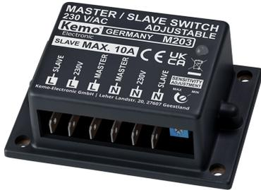
Schaltet automatisch beim Einschalten einer Maschine, Lampe usw. (Master) eine andere Last (Slave) ein. Die Gesamtleistung Master + Slave max. 3680 W (16 A), wobei die maximale „Slave“ Leistung 2300 W (10 A) beträgt. Die Masterlast-Empfindlichkeit ist einstellbar.
