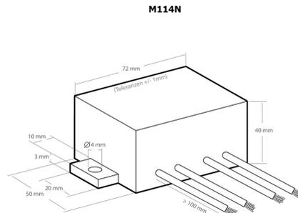
Luz intermitente lenta con periodo de flasheo ajustable: aprox. 0,6 - 9 segundos de tiempo de encendido. El tiempo de apagado es aproximadamente el 50% del tiempo de encendido, respectivamente. Contiene fusible: T 1,6 A. Lámparas incandescente o lámparas LED de 10 - 300 Watts, 240 V/AC (10 - 150 W a 110 V/AC).
