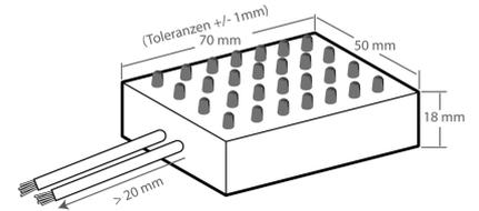
Mediante el proyector de luz infrarroja las cámaras CCD pueden percibir objetos también en tinieblas. Los hombres no pueden ver la luz infrarroja. Las cámaras CCD pueden ver muy bien con un proyector de luz infrarroja. Ideal para la observación "discreta" de entradas, accesos etc.
