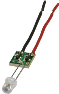
Este LED con tensión electrónica continua y soldada, se puede conectar a cada tensión de entre 4...30V=. El LED siempre alumbra con casi la misma luminosidad y tiene un consumo de corriente de aprox. 15mA. No se necesita un resistor protector adicional. Se puede cambiar el LED entregado por cualquier otro LED. Se pueden también conectar algunos LED's en serie. Tamaño de la placa: aprox. 10 x 13 mm.
