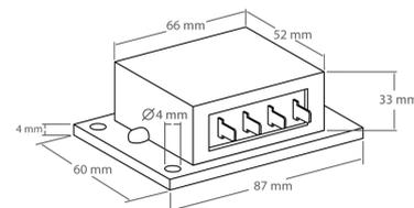
Este protector de acumulador protege su batería de coche contra descarga total por desconectar a tiempo dispositivos consumidores como cajas frigoríficas, calefacciones, radios + televisores, etc. Él se conecta de nuevo automáticamente cuando la tensión normal regresa. La tensión de desconexión es ajustable: aprox. 10,4....13,3 V.
