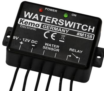
Cuando las 2 conexiones de sensor del módulo entran en contacto con agua, el relé incorporado se conecta. Con eso se pueden controlar sirenas, otros relés de desconexión, etc.
