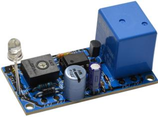
Conecta un relé cuando hay luz o oscuridad (sombra). Aplicación: el relé conmuta cuando se interrumpe el rayo de luz de una lámpara a puertas, ventanas, etc. por una persona. Se puede también emplear como interruptor crepuscular.
