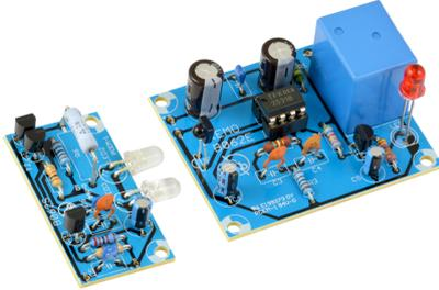
Barrera de luz con rayo de luz infrarrojo invisible. ¡Completo con emisor y receptor!
