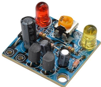
2 diodos luminosos de varios relucen por turno. Velocidad de intermitencias ajustable.
