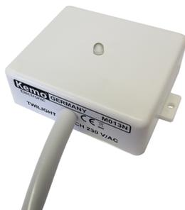
Este interruptor crepuscular electrónico conecta automáticamente lámparas (p.ej. lámparas economizadores de energía) u otros dispositivos consumidores al atardecer y desconecta de nuevo al amanecer por un relé instalado. El módulo puede también funcionar por el contrario: conectar al amanecer (para displays de publicidad, surtidores, etc.) y desconectar al atardecer. Se pueden conmutar libre de potencial cargas hasta 3 A.
