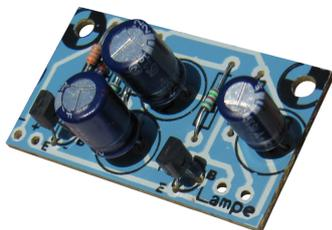
Aparato electrónico de luz intermitente para bombillitas. También se puede usar como flasher de señales alternativas. La frecuencia de luz intermitente es: aprox. 1 - 3 x por segundo. ¡Magnífico para la aplicación en modelos de miniatura! ¡Con el kit adicional "B197 - Tarjeta de relé 12 V/DC" (no incluido en este kit) se pueden accionar cargas hasta 6 A consumo de corriente consiguiendo luz intermitente!
