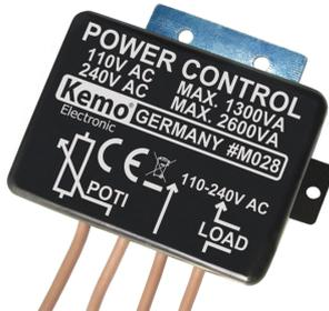
Para la regulación de cargas óhmicas + inductivas (p.ej. motores, calefacciones, bombillas, etc., si estos son controlables por corte de onda). No se pueden regular: p.ej. lámparas fluorescentes, motores con capacitor de arranque.
