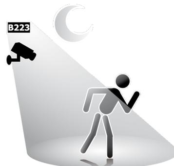
Mediante el proyector de luz infrarroja las cámaras CCD- y video pueden percibir objetos también en tinieblas. Hombres no pueden ver la luz infrarroja. Las cámaras CCD pueden ver muy bien con un proyector de luz infrarroja. Ideal para la observación "discreta" de entradas, accesos etc.
