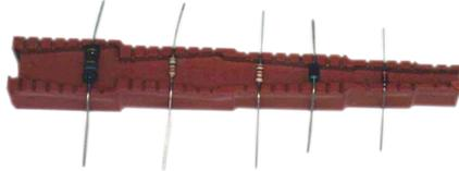
Para resistencias, diodos, bobinas de reactancia, condensadores de electrolito.
