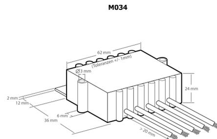
Módulo amplificador robusto para uso universal. El módulo es aprueba de humedad y de movimiento. El material del módulo consiste en un plástico especial, altamente conductor de calor.
