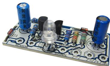
Siempre y cuando contacten los dos hilos desnudos con agua, el diodo luminoso alumbrará. El dispositivo es especialmente adecuado para indicar el rebosar de depósitos de recogida de agua de lluvia o de los canales de la casa. La tensión de servicio es: 9 V/DC.
