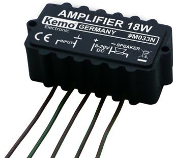
Módulo amplificador robusto para uso universal. El módulo es aprueba de humedad y de movimiento. El material del módulo consiste en un plástico especial, altamente conductor de calor. Por lo tanto no son necesarios disipadores de calor adicionales. El módulo está protegido electrónicamente contra sobrecarga y sobrecalentamiento.
