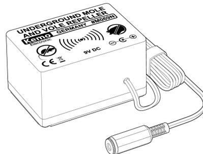
Este módulo a prueba de agua produce en intervalos rápidos oscilaciones agresivas y sísmicas que se extienden en la tierra y son evitadas en general por campañoles, topos y otros roedores semejantes. El módulo se entierra cerca de los pasos de los animales y está conectado con la tensión de servicio de 9 V/DC por un cable. El módulo es suficiente para 1000 m<sup>2</sup> superficie de jardín.
