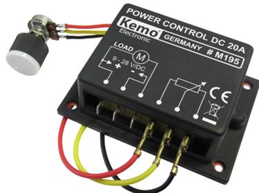
Regulador de poder para controlar cargas DC (motores DC, lámparas, calentadores, LEDs con resistores de corriente limitados, etc.) El uso del control PWM (anchuras de pulso) funciona muy bien aún con los motores eléctricos trabajando con RPM bajas. Frecuencia de conmutación: aprox. 300 - 600 Hz (en motores, es posible percibir un ligero sonido de vibración). El control de este se realiza via el potenciómetro incluido o con un controlador de voltaje externo 0 a 5 V/DC.
