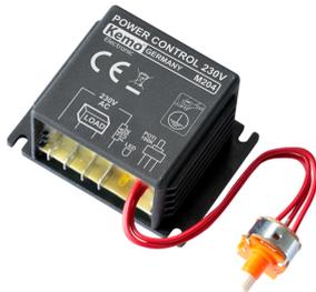
Regula sin supresión de interferencias adicionales cargas óhmicas como calefacciones, etc. con impulsos en pasaje por cero. La regulación se efectúa por conectar y desconectar de nuevo en impulsos. Por lo tanto, el regulador es solamente adecuado para calefacciones (placas calefactoras, varillas soldadoras, máquinas de soldar térmicas, hornos, etc.). No es adecuado para motores y lámparas (estos podrían estacionarse o parpadear, respectivamente).
