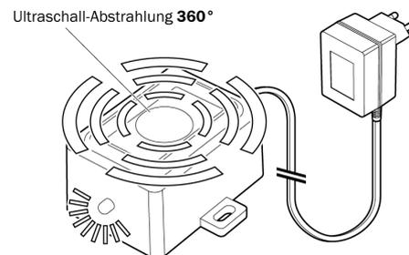
Con ultrasonido agresivo para el uso en el interior así como afuera. Produce sonidos ultrasónicos sinusoidales muy altos que martas etc. perciben como muy molesto y los animales los evitan si es posible. Los sonidos ultrasónicos no son audibles para el oído humano. El aparato de base es impermeable al agua según \*IP65 y se puede montar también afuera. El bloque de alimentación enchufable conectado se tiene que enchufar en una caja de enchufe en un lugar seco.
